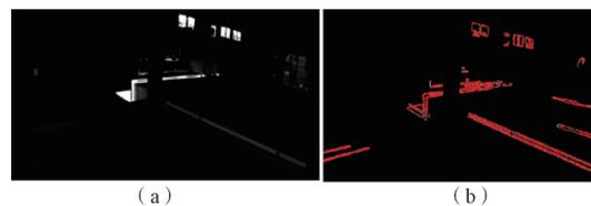
图 3 原图(a)和 Canny 边缘检测结果(b)
