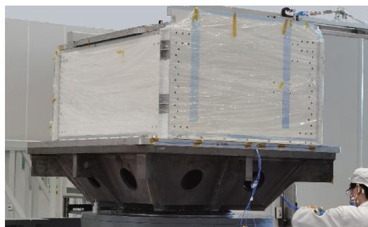
图10 Z轴振动试验现场
