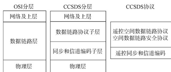
图8 遥控数据链路协议分层模型
