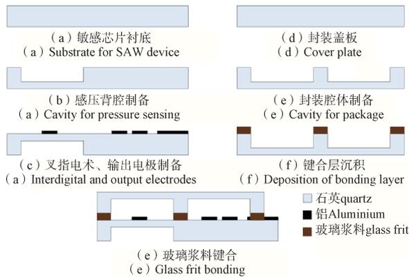
图5 全石英SAW压力传感器制备工艺流程
