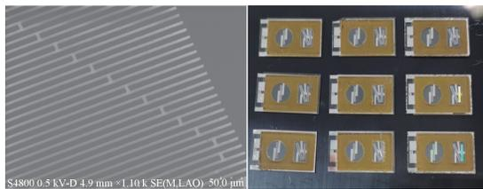
图6 全石英压力传感器制备
