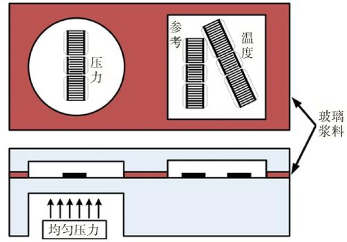
图1 全石英声表面波压力传感器结构示意图
