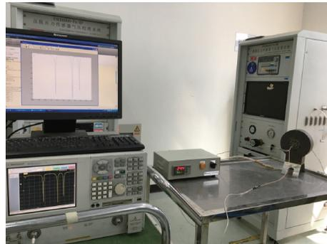
图7 SAW压力传感器系统测试平台
