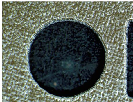
图 4 玻璃浆料键合结构预烧结后
