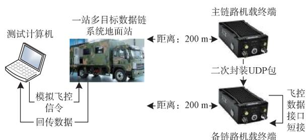
图5 一站多目标无人机信息融合技术拉距测试环境
