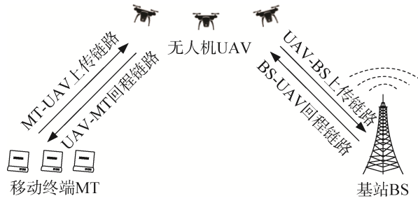
图 1 无人机中继辅助用户卸载系统图
