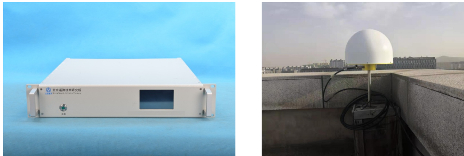
图 3 自研 BDSBAS 监测接收机及天线架设图
