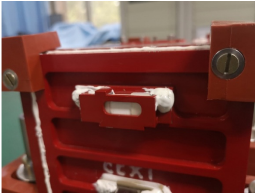
图 13 固定 LED 灯带 Fig. 13 Fixed LED strip
