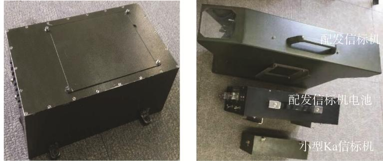
图 6 两种 Ka 信标机及外观对比图
