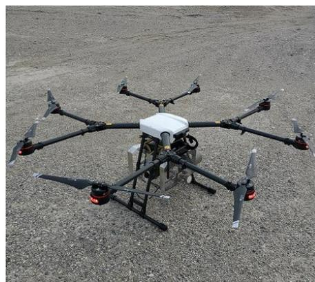
图 4 固定支架上机安装实物图
