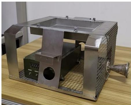
图 3 固定支架及信标机、喇叭安装实物图
