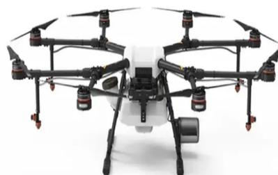
图 1 安装展开的 MG-1P 植保机
