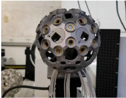
图3 ISOC 激光终端样机
