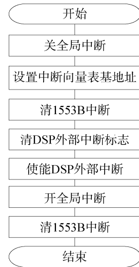
图 2 1553B 中断初始化流程
